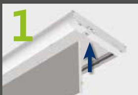
1 El panel de LED se coloca en la base y se asegura con un broche deslizante.
