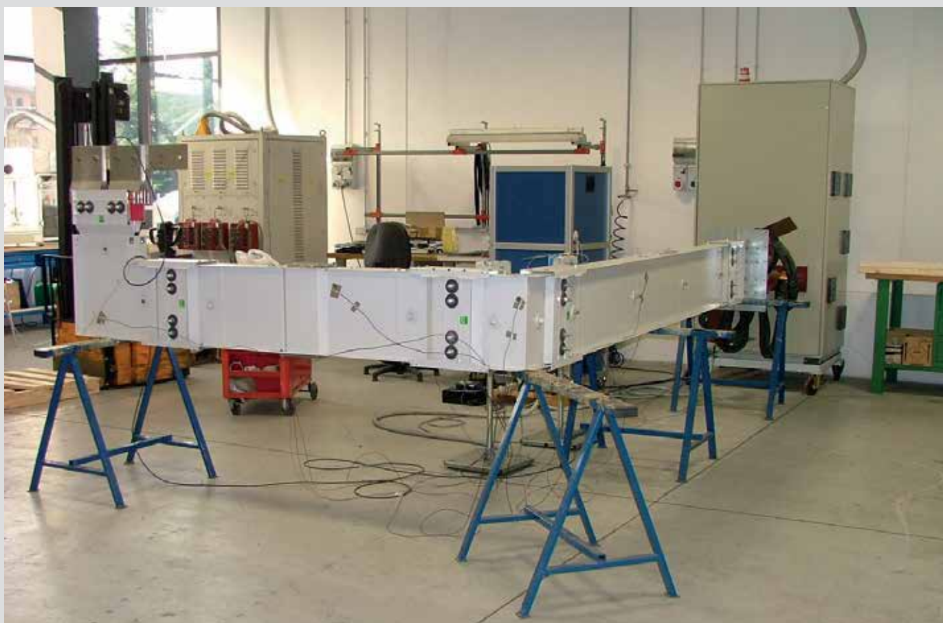
El laboratorio Legrand durante los ensayos para el certificado de homologación del sistema de electroducto XCP.
