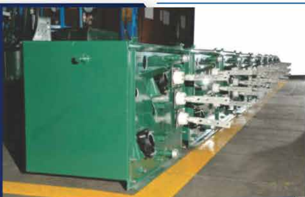
Colocación de accesorios al transformador
